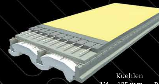
Eingefräste Fußbodenheizung mit Bodenbelag 2mm Polyurethaan WTP - Nr. 09128001 - 09128002 DIN-CERTO 7F247
